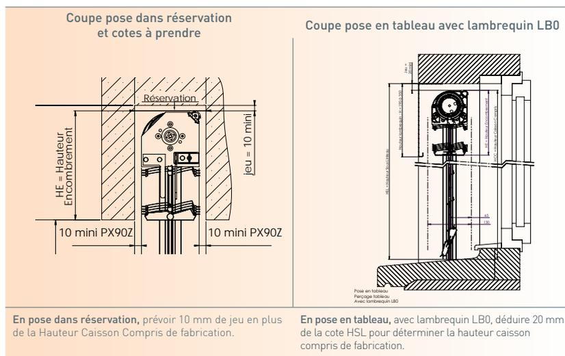
En pose dans réservation, prévoir 10 mm de jeu en plus de la Hauteur Caisson Compris de fabrication.
