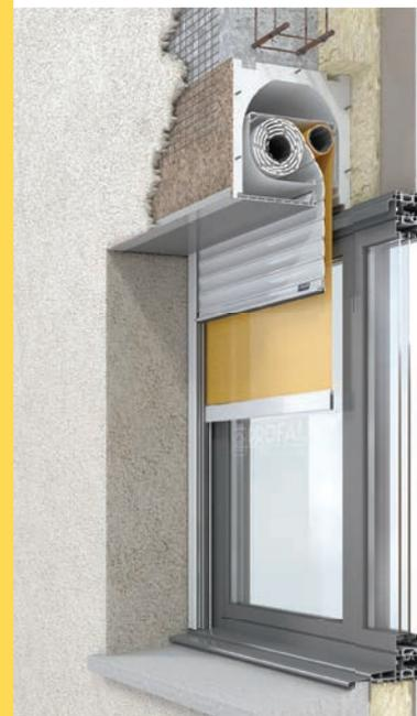
Possible aussi en construction traditionnelle avec Isolation Thermique par l'Extérieur
